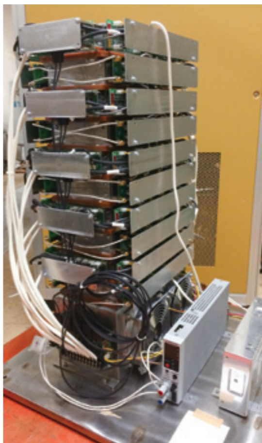
高精度なパルスパワーを安定的に発生できる「高電圧半導体スイッチ」
